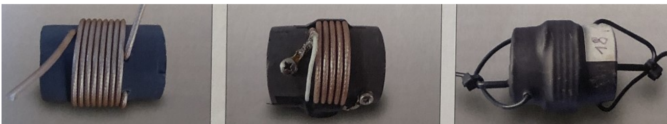
De sperkringen van DK4FD in achtereenvolgende fasen van afwerking
